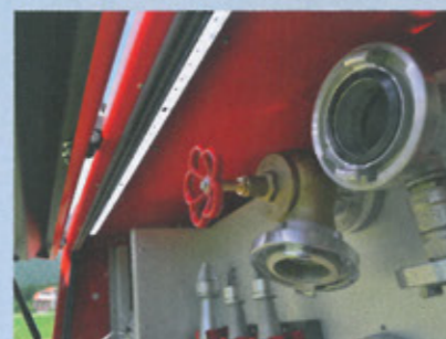
Die Geräteraume der Module sind mit nach oben öffnenden Klappen verschlossen und mit LED-Lichtleisten versehen.
