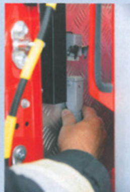
Nach dem Be- oder Entladen der Module wird jeweils die Stromverbindung per Stecker hergestellt oder getrennt.
