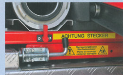
Detail des Tragkraftspritzen-Containers: oben die Arretierung für ein Saugrohr, unten der Verriegelungsbolzen für das Modul.
