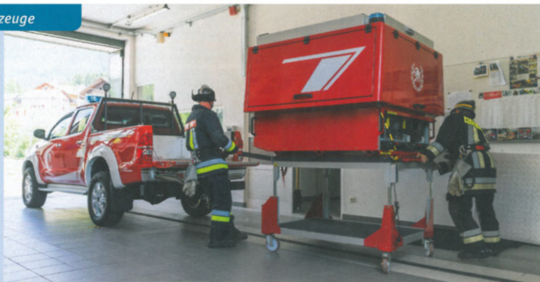
Sowohl die Module als auch die Wagen, auf denen diese im Feuerwehrhaus bereitstehen, sind mit Rollen ausgestattet. So lassen sich die Container mit wenigen Handgriffen auf den Pick-up ziehen.
