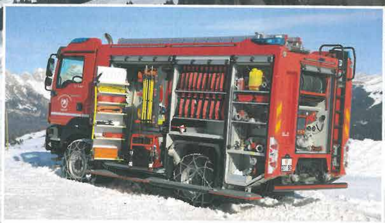
Die Geräteräume des TLF-A 2000 sind gut bestückt, aber nicht vollgepackt bis unter das Dach. So bleibt noch immer etwas Luft für nachträglich beschaffte Ausrüstung.
