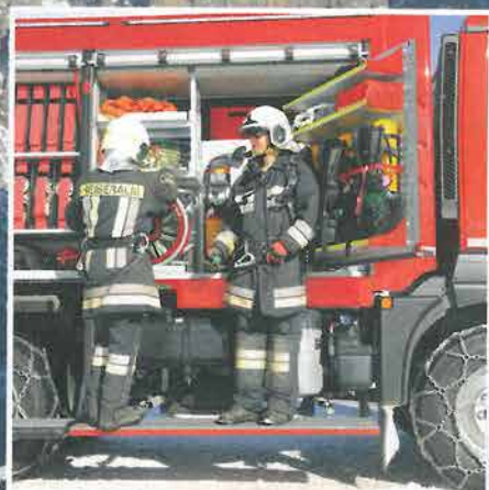
Drei Pressluftatmer gehören zur Beladung des TLF-A 2000 und sind auf der Innenseite einer Schwenkwand im G2 geladen. Von der abklappbaren Bordwand aus können sie nacheinander direkt angelegt werden.
